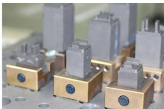
当第一批电极装载到料架后，系统优先抓取一个电极到机床，保障设备先运作起来；当所有电极装载到料架后，系统根据扫描得到的信息进行排产，操作员可在工控机的显示屏上查询排产信息，按需求对排产的顺序做调整；加工过程中操作员可在显示屏上查看设备的加工状态和进度状况。
