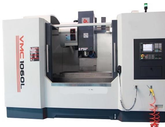
选用立式加工中心，主轴轴线与工作台垂直设置的加工中心，主要适用于加工板类、盘类、模具及小型壳体类复杂零件。立式加工中心能完成铣、镗削、钻削、攻螺纹和用切削螺纹等工序。
