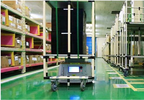
**智能移动:** 基于自然无轨导航技术, 机器人根据数字地图, 实现自主移动, 无需铺设磁条、磁钉;
